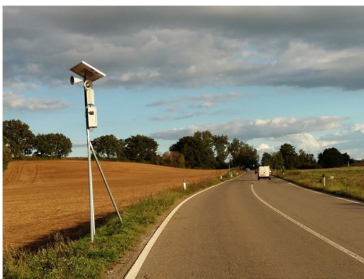
Figura 5.2. Dispositius que emeten gravacions de sons (variables segons l'espècie objectiu).
