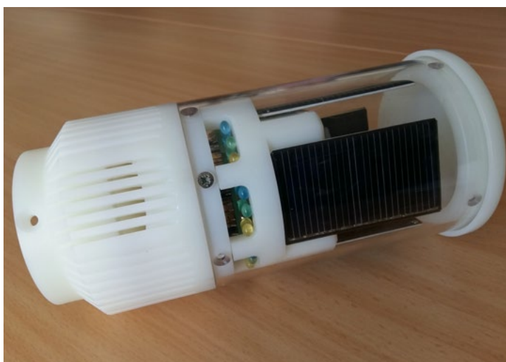
Figura 5.4. Dispositius electrònics que es munten sobre pals de subjecció i emeten sons i pols lluminosos.
